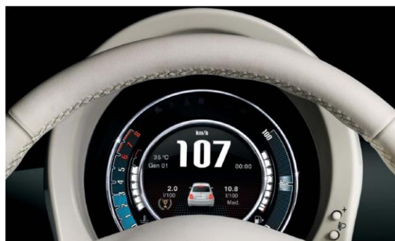
Цифрова РК-панель приладів TFT з кольоровим дисплеєм 7"
