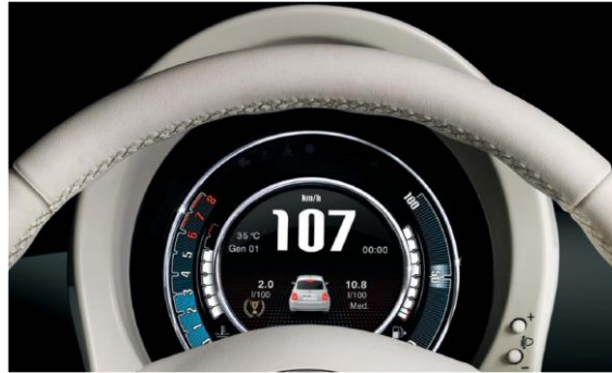
Цифрова РК-панель приладів TFT з кольоровим дисплеєм 7"
