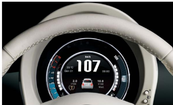
Цифрова РК-панель приладів TFT з кольоровим дисплеєм 7"
